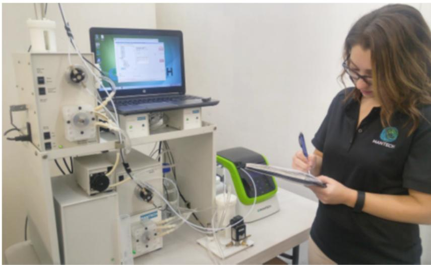
L100在线分析仪是一种L100 PeCOD® 自动分析仪，它可以按照指定的时间间隔进行连续取样。它可以自动校正，润洗，进行质量控制检查，以及样品分析。如果pH值在理想的范围(4-10)以外，可以选择进行pH的自动调节。如果样品组分浓度超过了工作限定值，可以选择进行对样品的稀释。采样仪可以放置在推车上进行移动，也可以放在柜子里。要求最小样品流速为10 mL/min，并且连接到去离子水容器。系统本身不具有自动过滤的功能，因此样品在放入自动进样器前需保证样品组分中不含有大颗粒物。含有较大颗粒物负荷的样品如果有额外的时间进行静置沉淀，也可以使用该仪器进行分析。
